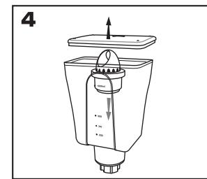
フタを開けカートリッジをタンク上方から押さえつけるように最下部まで押し込んでセットしてください。
