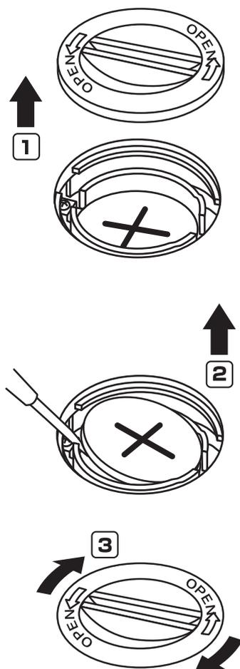
① 裏側の電池カバーを矢印の方向に回して、取り外します。
