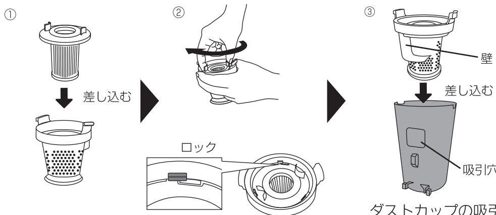
ダストカップの吸引穴とフィルターカバーの壁を合わせるようにして差し込む
