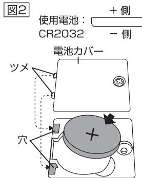
■本製品は、新しい正常な電池を組み込んだ場合、約1年間作動します。(1日30秒アラームを鳴らした場合、またはパイプを作動した場合)
