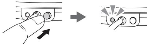
※約4時間経過するとLEDランプが点灯から点滅に変わり、自動的に加熱が停止します。(LEDランプは消灯しません。)
