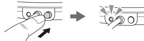
※約 4 時間経過すると LED ランプが点灯から点滅に変わり、自動的に加熱が停止します。
