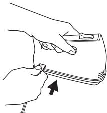
ビーター軸凸部をビーター差し込み口の溝に合わせ、カチッと音がして止まるまでしっかりと差し込んでください。
