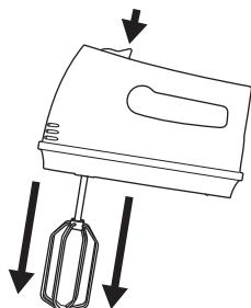
スイッチを「0」にした状態でPUSHボタンを下に押し下げるとビーターがはずれます。
