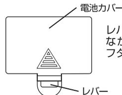
レバーを矢印の方向へ押しながら、上に引き上げてフタを開けてください。
