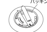
3. 電池カバーの○マークを本体の○マークに合わせてセットし、コインなどで「CLOSE」の方向へ回して閉じる。
