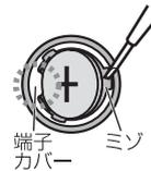
※電池は+側を上にして、端子カバーの下側に差し込むように入れてください。
