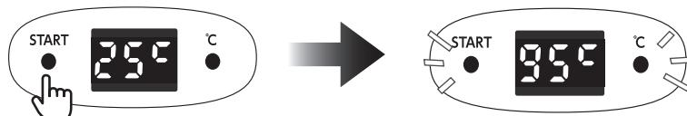
※約 30 秒操作しないと表示部が消え、「START」ボタン部の赤ランプのみが点滅します。
