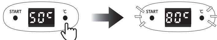
※約30秒操作しないと表示部が消え、赤ランプのみが点滅状態になります。
