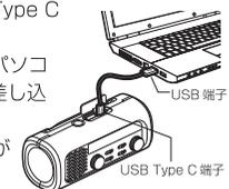
5. 約1.5分経過したら必ず充電用ケーブルをはずして、本体に収納する。
