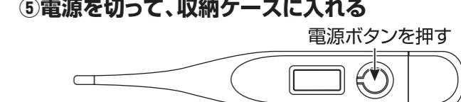
※本製品は電源を入れた状態で放置した場合でも、電源を入れてから約12分後に自動的に電源が切れよう設計されていますが、電池の消耗を防ぐため検温終了後は電源ボタンを押して電源を切ってください。
