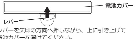
レバーを矢印の方向へ押しながら、上に引き上げて電池カバーを開けてください。
