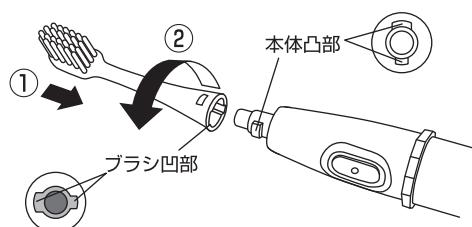
※ブラシの凹部と本体の凸部を図のように合わせてさし込みます。
