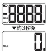
「入／切」ボタンに触れて電源を入れます。同時にバックライトが点灯します。（約10秒間）
