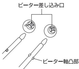
ビーター軸凸部をビーター差し込み口のミゾに合わせ、カチッと音がして止まるまでしっかりと差し込んでください。スイッチが「切」になっていることを確認し、電源プラグをコンセントに差し込みます。
